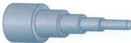
Si el flujo es laminar, el líquido fluye formando cilindros concéntricos.
