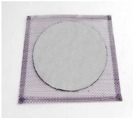
Tela de amianto
