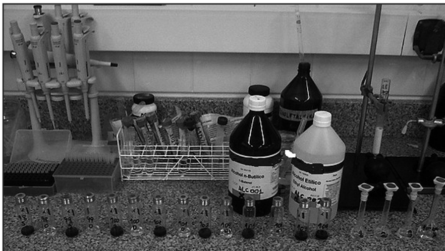
Figura 17 B. Viales de head-space para dosaje de etanol en muestras biológicas.
