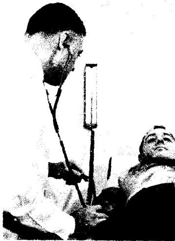
FIGURA 7.14 Medida de la presión sanguínea por medio de un manómetro clínico con una sola columna visible de mercurio. (W. A. Baum Co. Inc.)
