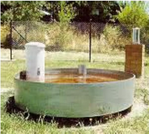
**Tanque evaporímetro:** Instrumento utilizado para medir la evaporación efectiva. Junto con un pluviómetro, un anemómetro, un termómetro y un pozo tranquilizador forma una estación evaporimétrica. Es el más usado, mide los milímetros que se evaporó del tanque.
