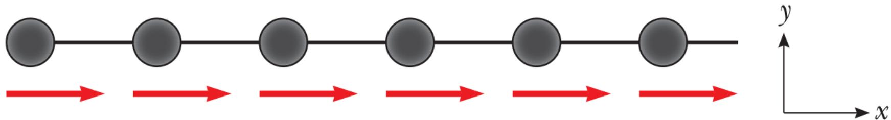
Después de aplicar al disco un soplido en la dirección  $y$ , el disco gana una componente  $y$  de velocidad, pero la componente  $x$  no es afectada por la fuerza en la dirección perpendicular.
