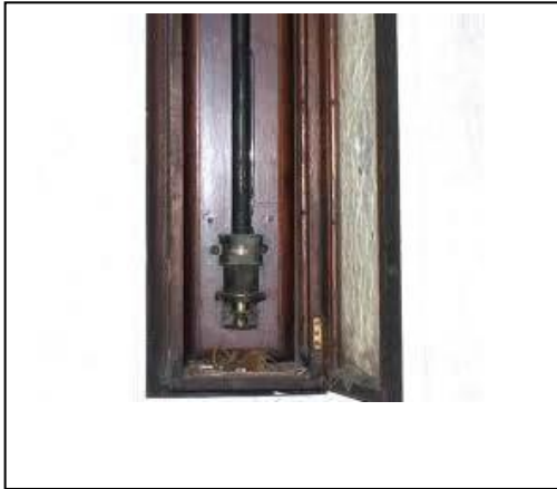
Figura 17. Barómetro de mercurio tipo fortin
