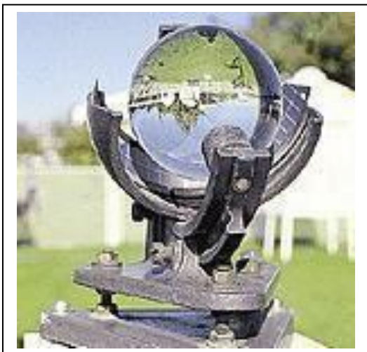
Figura 10 a) Registrador de insolación o heliofanía b) fajas utilizadas en latitudes medias y altas
