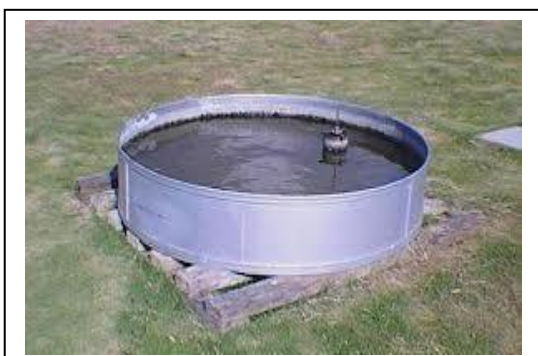
F21. Vasija de evaporación clase A tanque.
