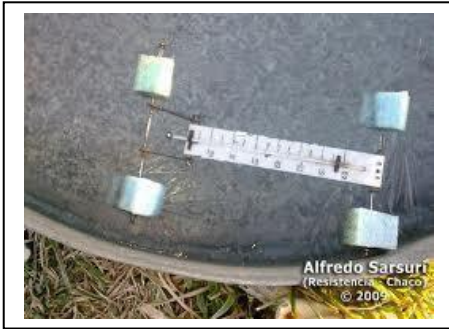
F23. Termómetro de temperatura de tanque.
