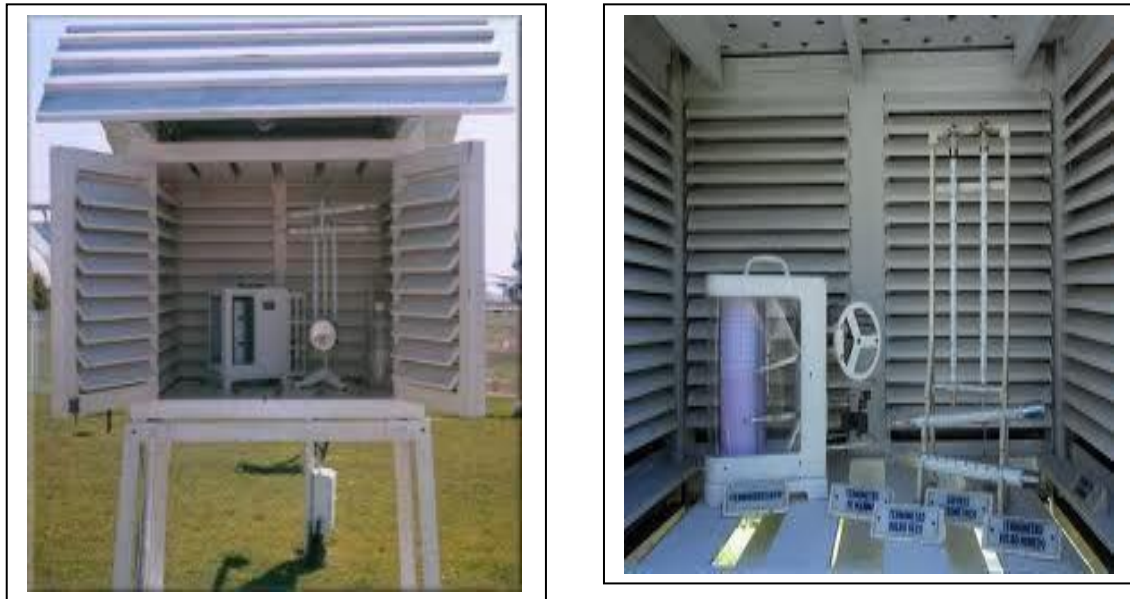
Figura 26. Abrigo meteorológico e instrumental en su interior.
