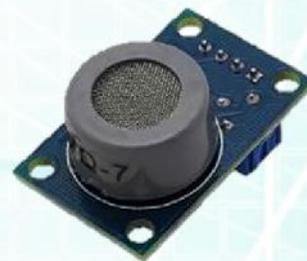
**Sensor de gas y unidad ensamblada con alarma**
