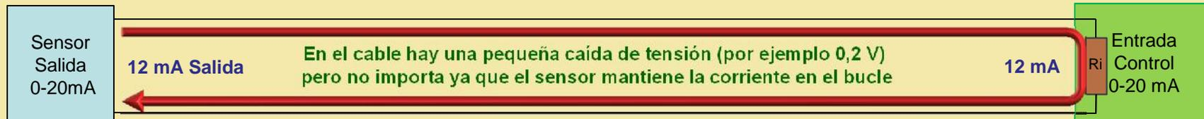
Existe **otra modalidad de bucle de corriente, la salida 4-20 mA**, donde **el valor mínimo es 4 mA** y el máximo 20 mA. En los **sistemas anteriores, 0V o 0 mA equivalen al valor mínimo del sensor** y si el sensor está averiado o la conexión se interrumpe **podemos 'recibir' un valor 0 que es erróneo**. Con el **bucle 4-20 mA**, en **caso de rotura del conductor recibiríamos 0 mA** y sabríamos que **es un error**, ya que el **valor mínimo es 4 mA**.
