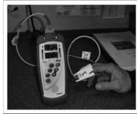
Es un método espectrofotométrico que se basa en que la COHb absorbe y transmite a determinadas longitudes de onda del espectro luminoso para la luz roja (640-660 nm) y la luz infrarroja (910-940 nm).
